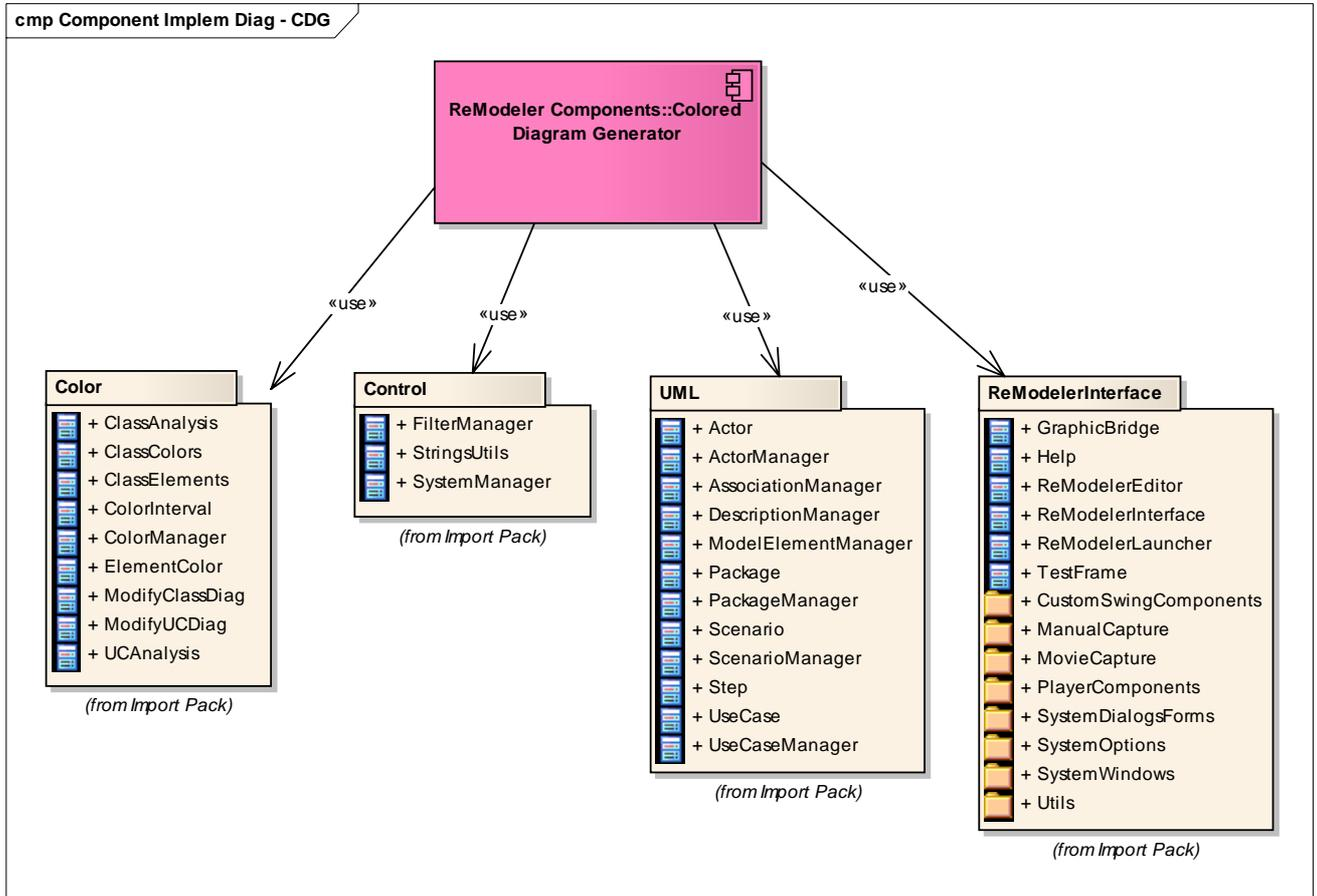
Figura 40. Implementação de Componentes – Colored Diagram Generator.
