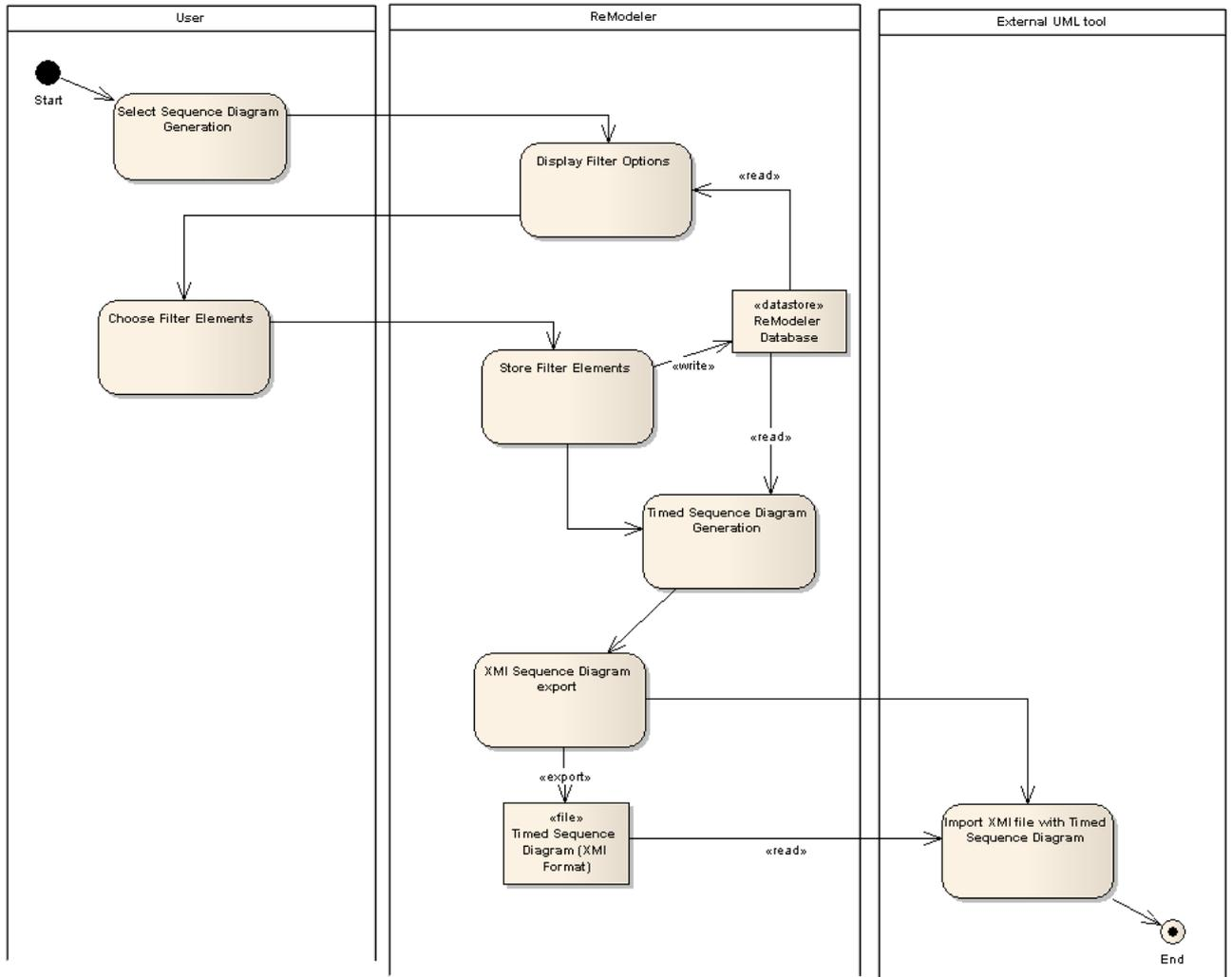
**Figura 27. Processo de geração e visualização de diagramas de seqüência.**
