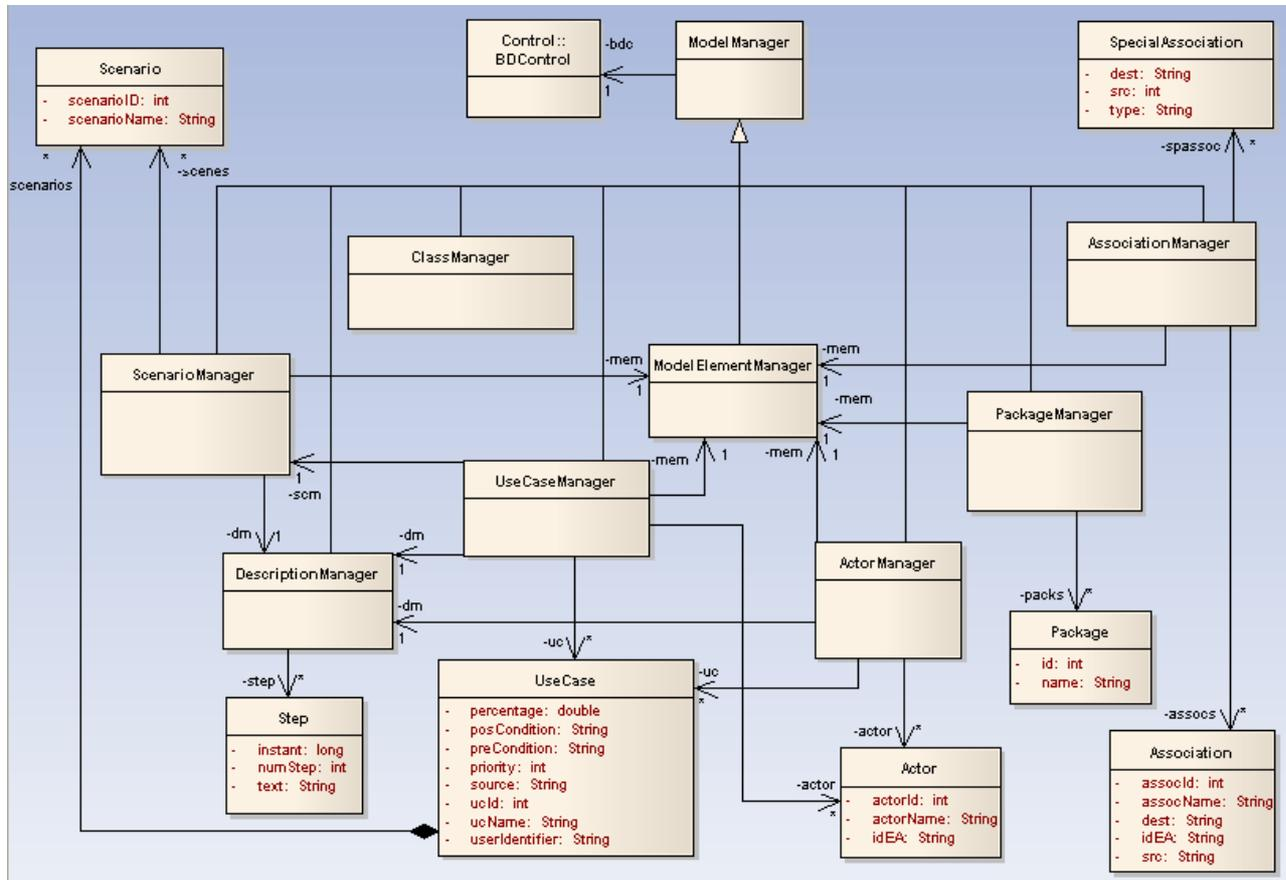
Figura 66. Diagrama de classes do pacote UML.
