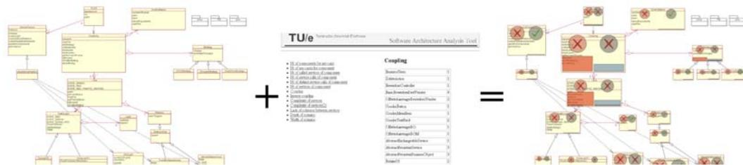
**Figura 114** Processo descrito em *MetricView*, em que a partir de um digrama UML e de resultados de métricas em formato tabular, se consegue um novo modo de visualização dos diagramas
