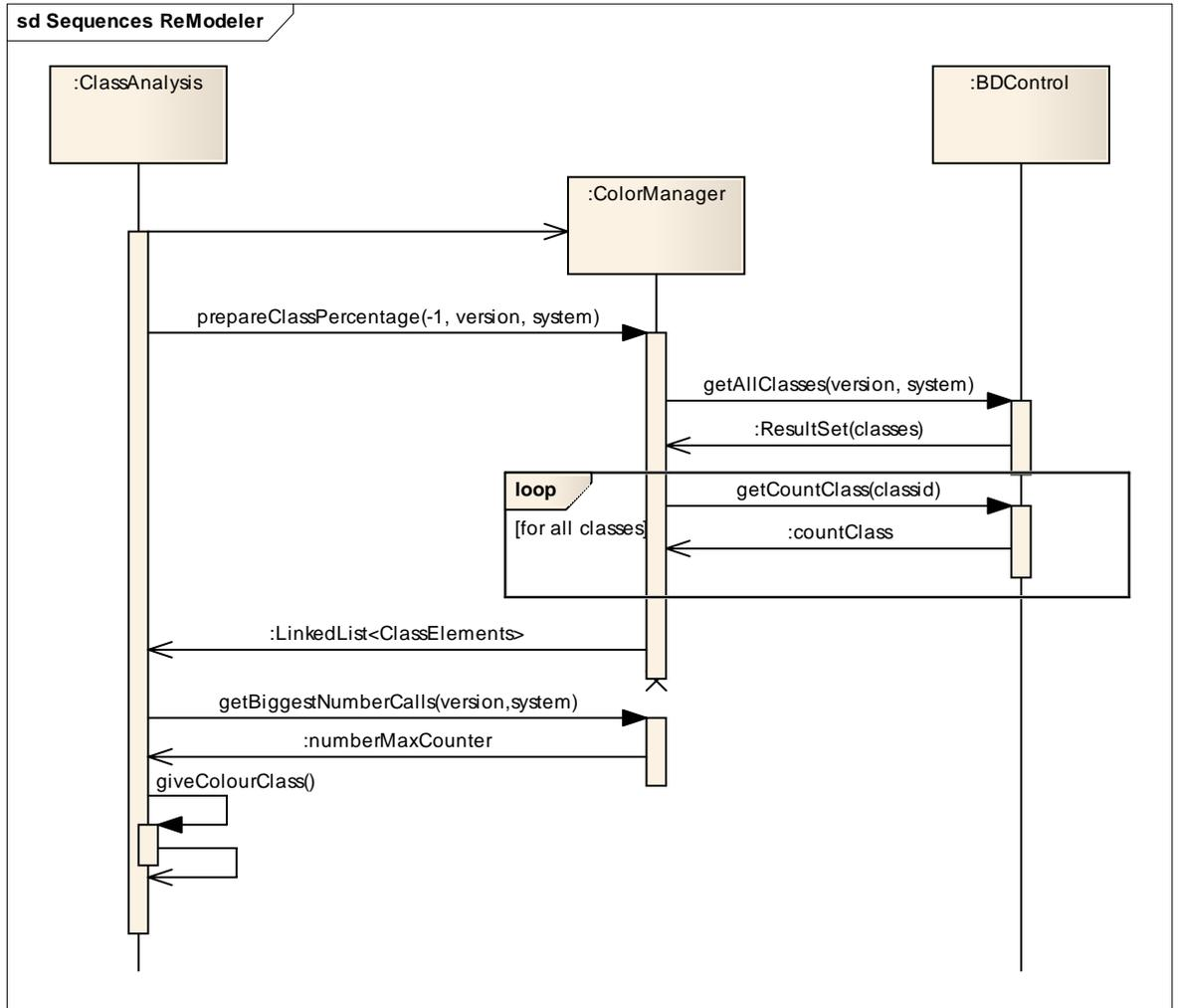
Figura 77. Diagrama de seqüência das acções da classe *ClassAnalysis*.
