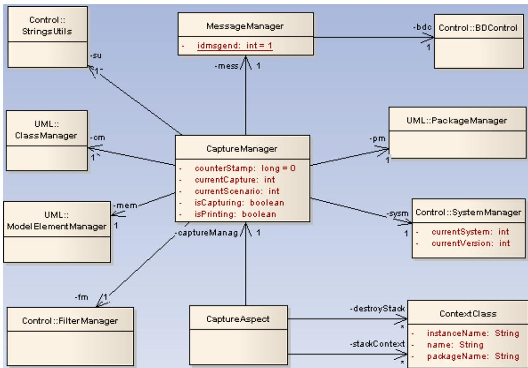
Figura 58. Diagrama de Classes para o pacote *Capture*.
