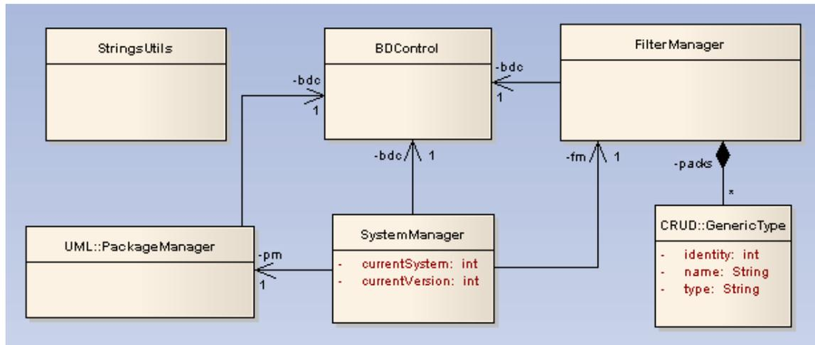
Figura 50. Diagrama de Classes para o pacote *Control*.
