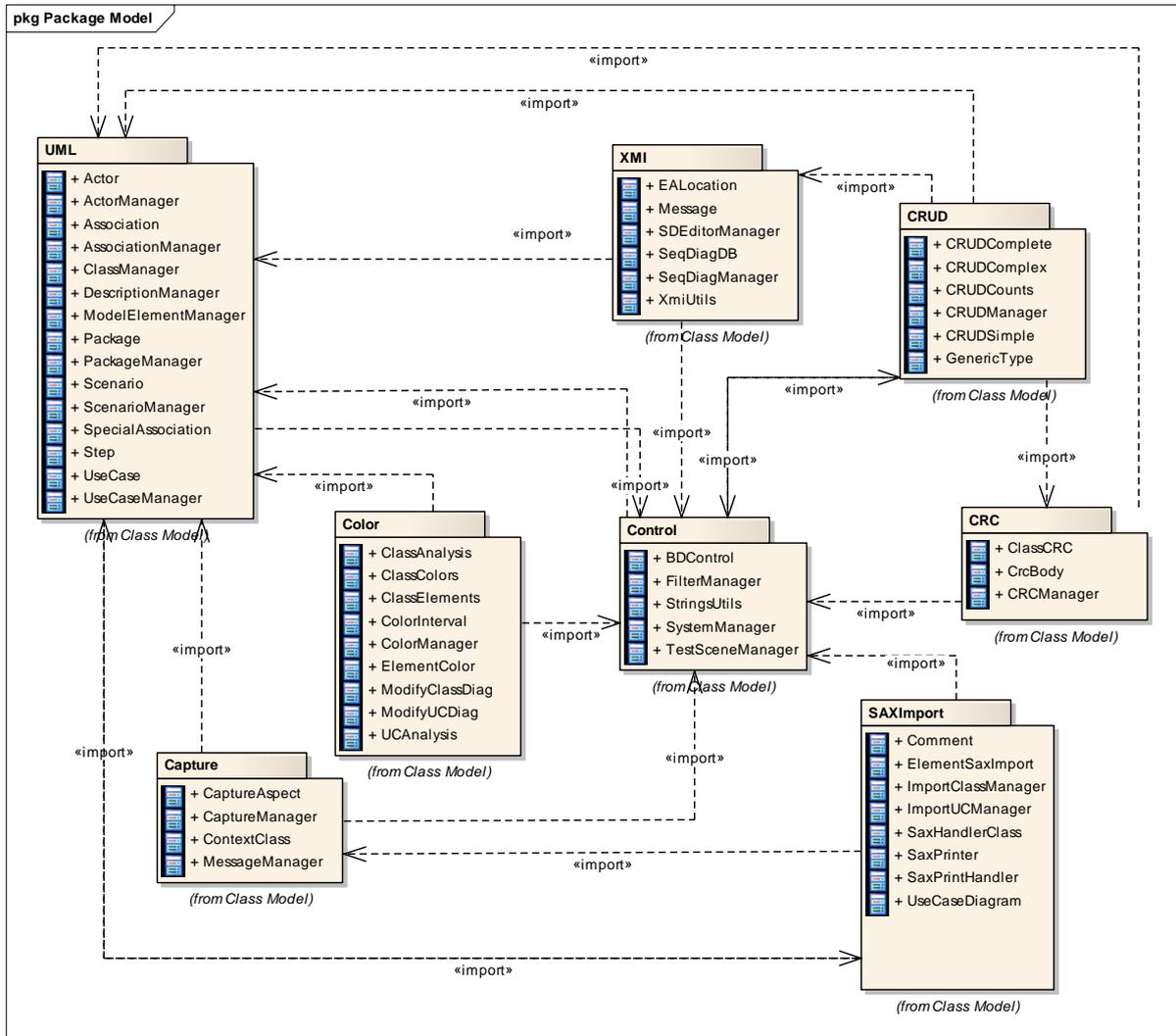
Figura 49. Diagrama de Pacotes para o sistema *ReModeler*
