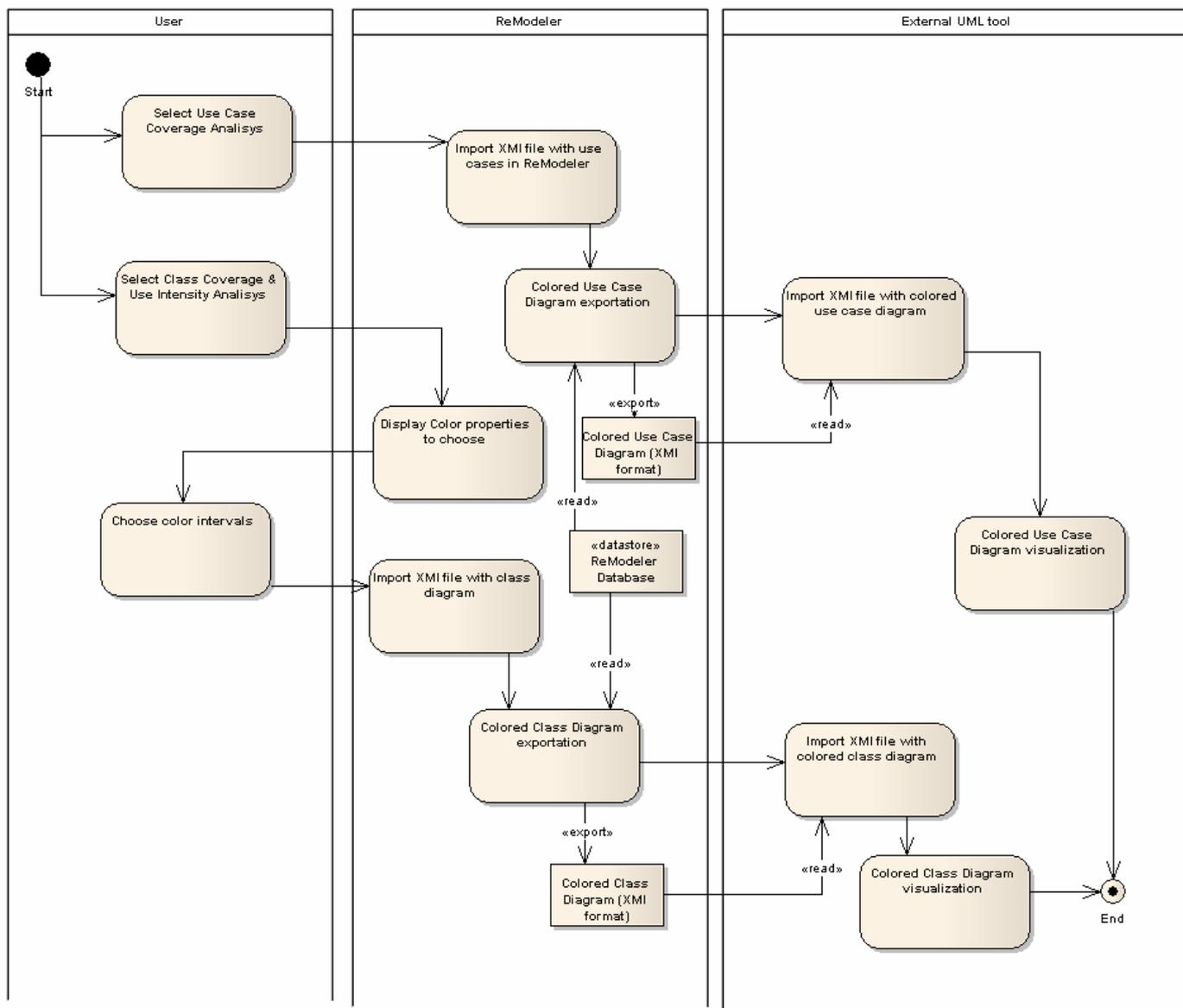
Figura 32. Processo de análise de testes de cobertura.
