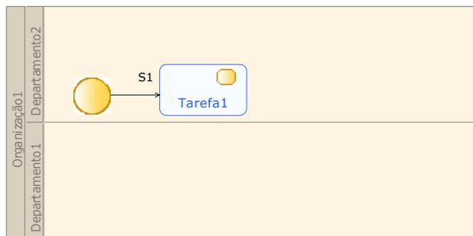
Figura 53 - Exemplo de Ligação Interna com Sequence Flow S1
